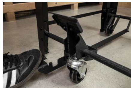
Obr.11. Pedál je nahoře – podstavec stojí na nohách a kolečka jsou zvednutá
